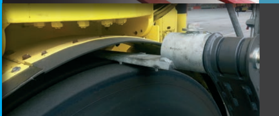
Плоский верхний рычаг для ограниченного зазора между шинами
