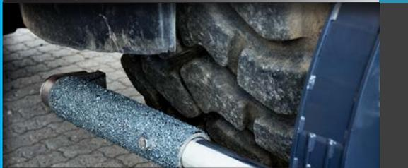
Телескопические трубы для большой досягаемости
