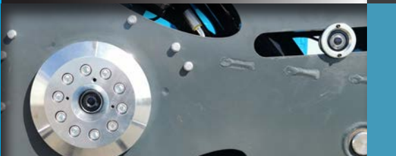
Система из 2 камер - для центровки ступиц и болтов
