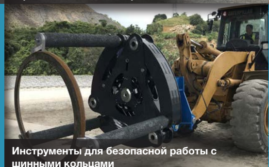
Модуль наклона на 35° или 90° - от горизонтального до вертикального положения
