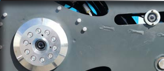
Система из 2 камер - для центровки ступиц и болтов
