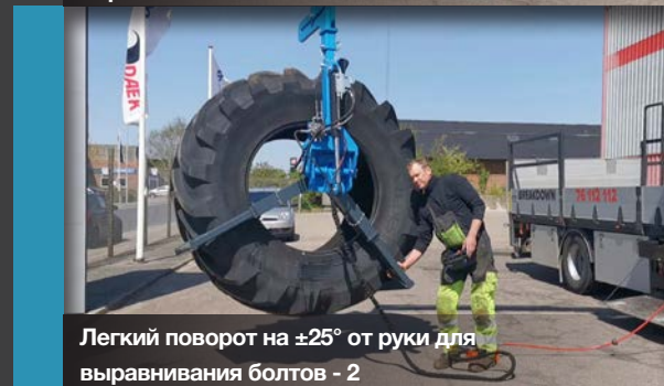
Легкий поворот на \pm 25^\circ от руки для выравнивания болтов - 1
