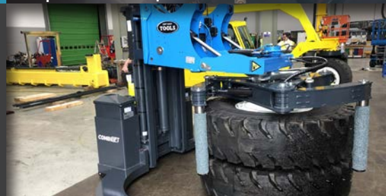
Точный наклон на 90°, от горизонтали до вертикали
